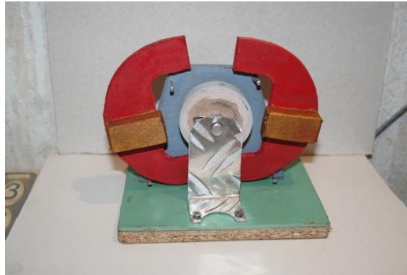
Die Kiefer kippen auseinander, weil die Magnete auf der Scheibe weggedreht werden
