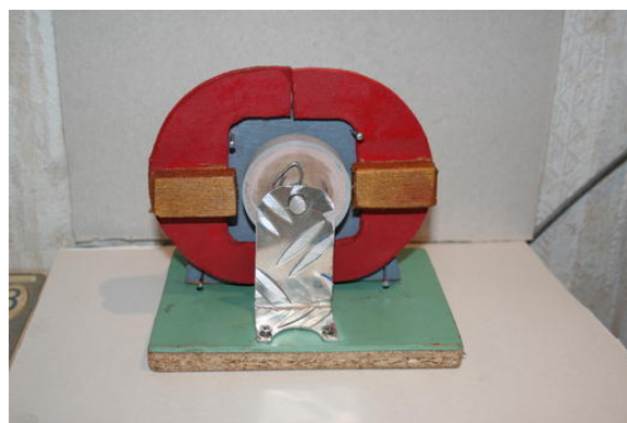
Die Magnete am Rand werden angezogen - die Kiefer schliessen sich
